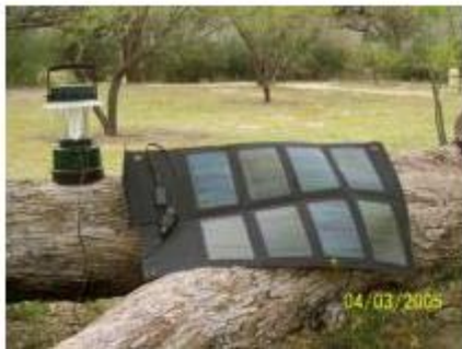
Sunlinq cargando la batería de una lámpara portátil
